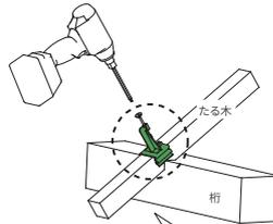
3 たる木ネジサポートを外し、タルキーネジを最後まで打ち込みます。
