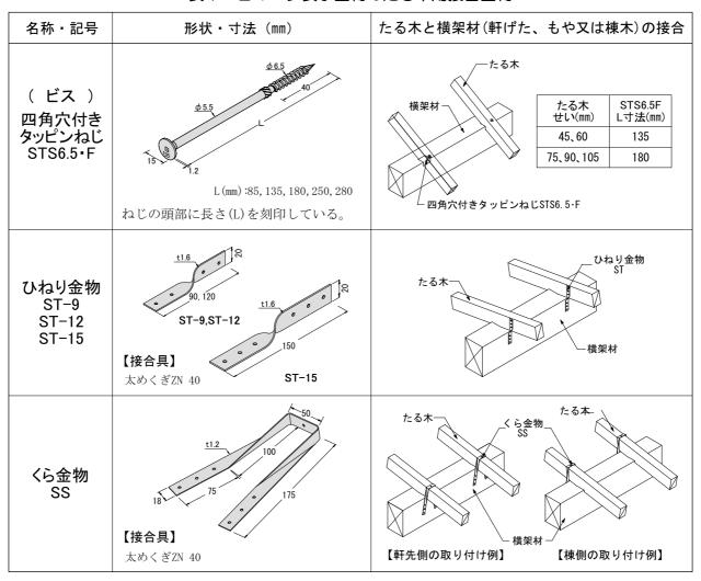
表2 Zマーク表示金物のたる木用接合金物の許容耐力(kN)
