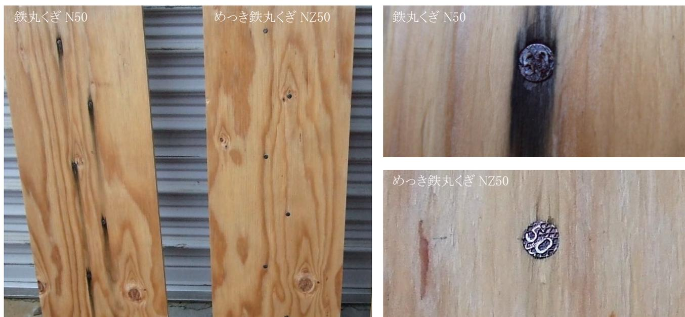
めっき未処理の一般的なくぎと亜鉛めっきを施したくぎの33日後の比較実験。右上が一般的なくぎ「鉄丸くぎ N50」で既にくぎ打ち部分の周りが黒くなっている。対して、右下が亜鉛めっきを施したくぎ「めっき鉄丸くぎ NZ50」で変化は起きていない。くぎ打ち部分の周りが黒くなっているのは“木材中のフェノール成分と鉄イオンとが化学反応を起こし、黒色の錯化合物を作るためである。”この化学反応を抑える為にはめっき処理が有効です。
