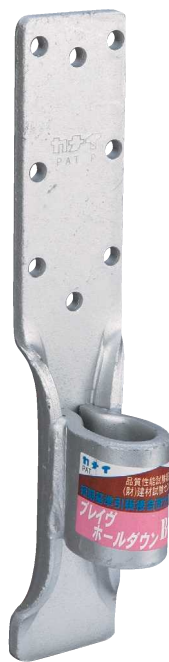
B-HD25 短期耐力 25.6 kN N値 4.8 以下 告示1460 り
