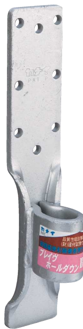
B-HD25 短期耐力 25.6 kN N値 4.8 以下 告示1460 り
